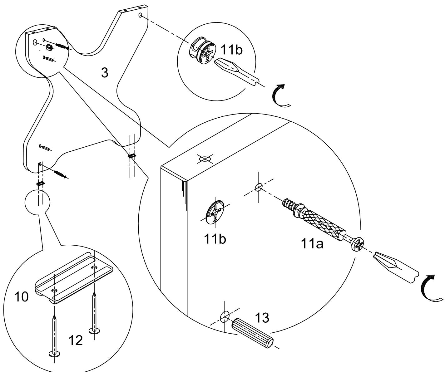
7.4. В отверстия Ø5 в столешнице (1) вкрутить стойки эксцентриков (11a), а в отверстия Ø8 вставить шканты (13).
