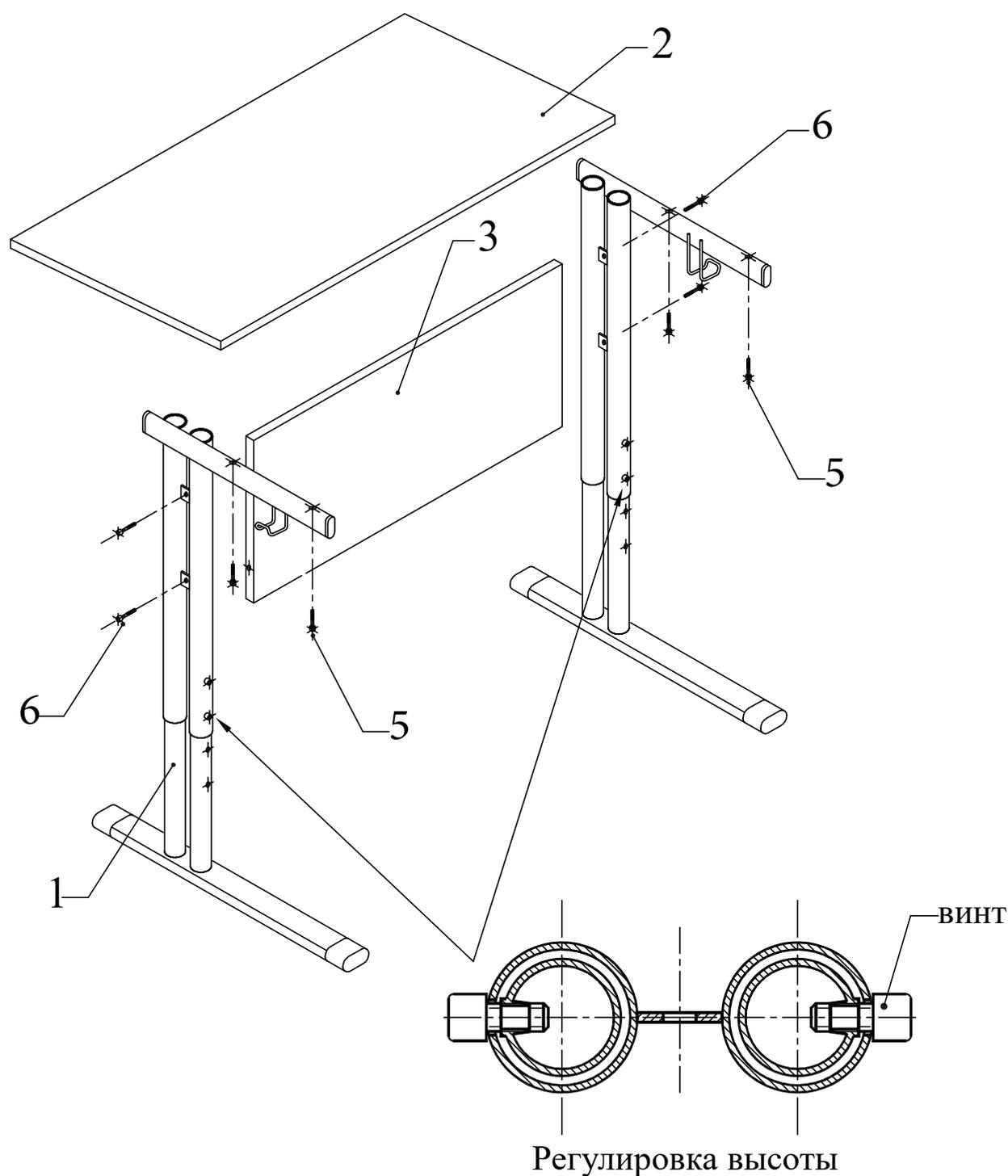
6.1. При помощи винтов (6) соединить боковины (1) экраном (3).
