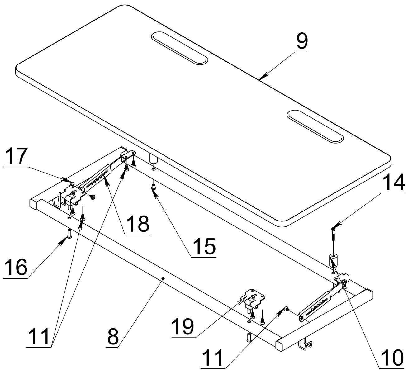
**ВНИМАНИЕ** - для регулировки группы роста выкрутить по два винта в каждой боковине стола, переместить опоры на требуемую высоту до совпадения отверстий, закрутить и затянуть винты вновь!
